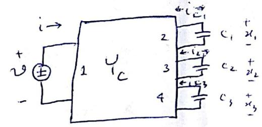
$$\begin{bmatrix} i \\ i_{c1} \\ i_{c2} \\ i_{c3} \end{bmatrix} = Y_c \begin{bmatrix} v \\ x_1 \\ x_2 \\ x_3 \end{bmatrix} = \begin{bmatrix} D & C \\ -C_{int}^B & -C_{int}^A \end{bmatrix} \begin{bmatrix} v \\ x_1 \\ x_2 \\ x_3 \end{bmatrix}$$
