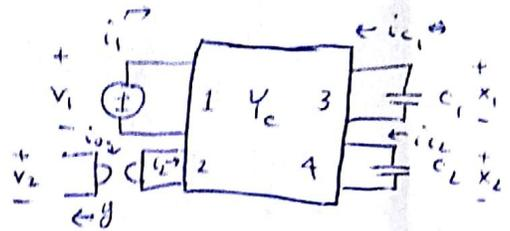
$$\text{Then, } \begin{bmatrix} i_1 \\ i_2 \\ i_{c1} \\ i_{c2} \end{bmatrix} = Y_c \begin{bmatrix} v_1 \\ v_2 \\ x_1 \\ x_2 \end{bmatrix}$$
