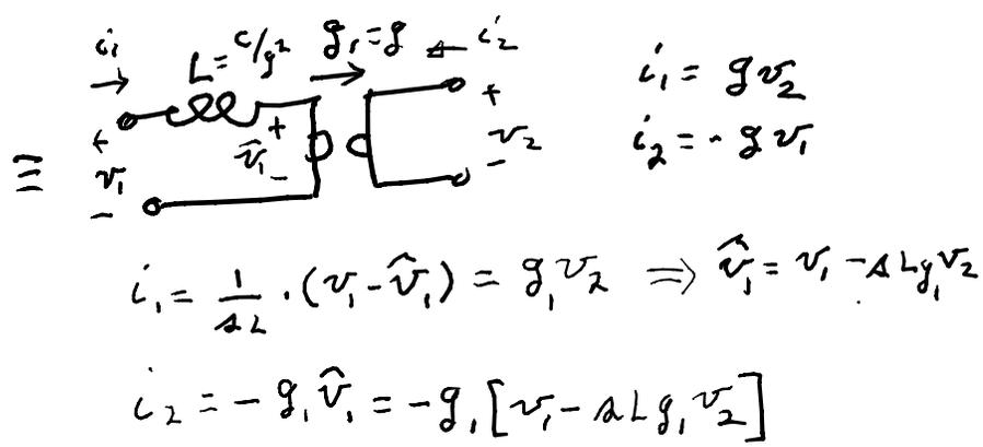
$$\begin{bmatrix} i_1 \\ i_2 \end{bmatrix} = \begin{bmatrix} 0 & g \\ -g & 2C \end{bmatrix} \begin{bmatrix} v_1 \\ v_2 \end{bmatrix}$$
