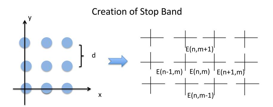
$$\begin{bmatrix} \omega^2 - \omega_c^2 \end{bmatrix} E(n,m) = \frac{\delta}{2} \omega_c^2 \begin{bmatrix} E(n+1,m) + E(n-1,m) + E(n,m+1) + E(n,m-1) \end{bmatrix}$$
